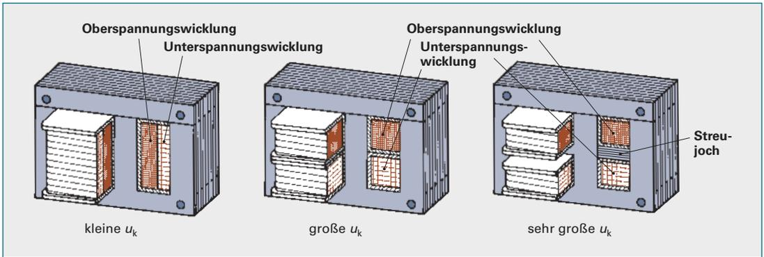
Bild 1: Beeinflussung der Kurzschlussspannung durch Anordnung der Wicklung
